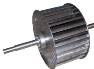
図 1 試作水車の外観写真
